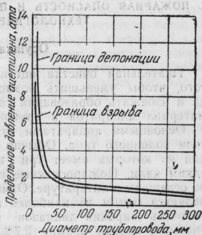
Рис. 3. Предельное давление взрывного и детонационного распада ацетилена в зависимости от диаметра трубопровода
