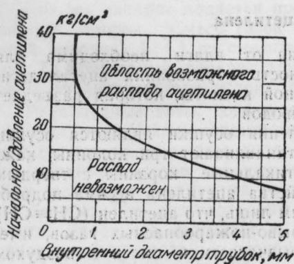
Рис. 2. Давление взрывного распада ацетилена в зависимости от диаметра труб
